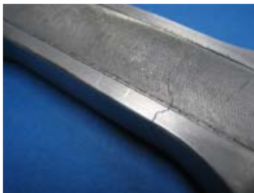
図 7 試験片 C6 に発生した疲労亀裂
