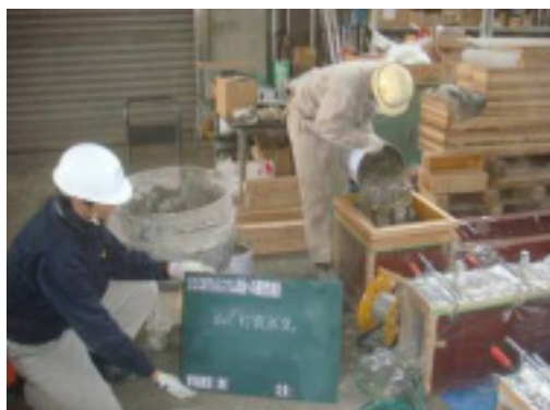
図-A.4 ECC の打込み状況
