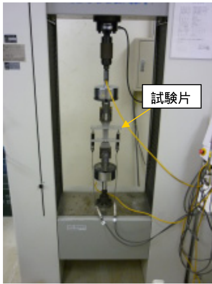
図-2.2 一軸直接引張試験
