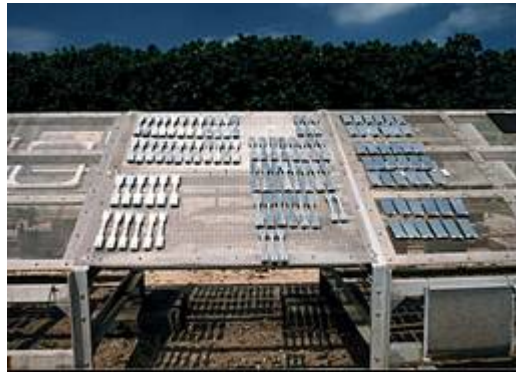
図 3.1 試験片の大気曝露状況
